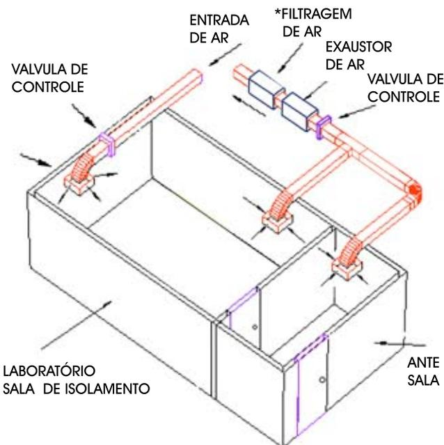
Se configurada para Pressão Positiva o ar deve fluir da sala de isolamento em direção a ante sala, onde será efetuada a exaustão do ar pelo exaustor da ante sala e em parte fluindo em direção ao corredor do prédio
